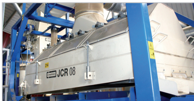
Vzduchově-sítový tříděč JCR 08 třídí materiál současně na sítích a pomocí vzduchu Foto Jana Pančíková
