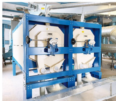
JK Machinery rozšířila nabídku o triéry vlastní konstrukce ve výkonových řadách 1,5 t/h – 5 t/h – 10 t/h. Na obrázku je paralelní instalace dvou triérů JCT 930 o sdruženém výkonu 20 t/h u belgické nadnárodní sladovnické společnosti Boortmalt. Linka byla zprovozněna letos v dubnu Foto archiv JK Machinery
